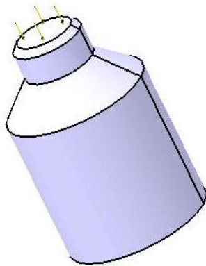
Figure 48 : modèle statique de calcul de l'outil de déboutonnage
