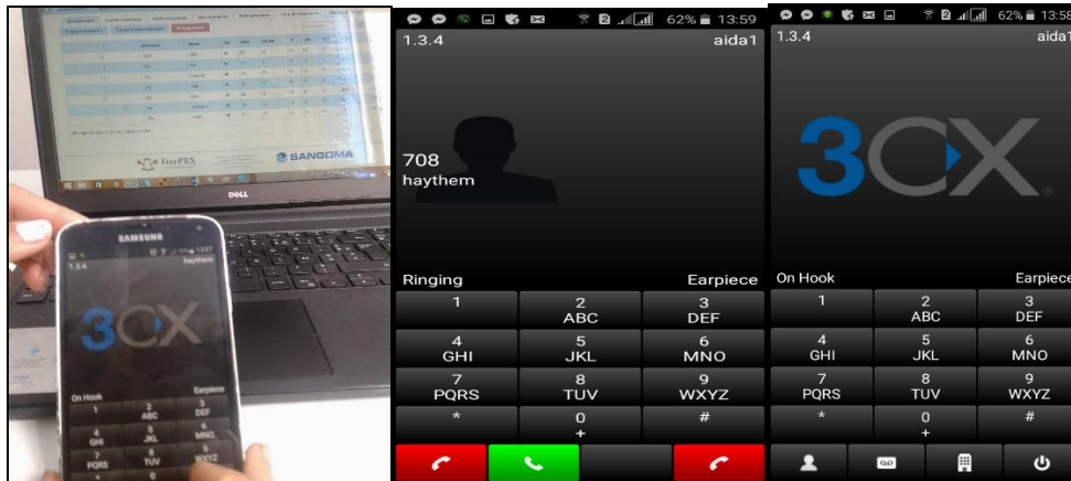
Figure 37: Test d'un appel entre deux téléphones Android
