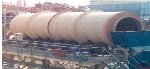
Figure4 : Crible vibrant + Débourbeur
