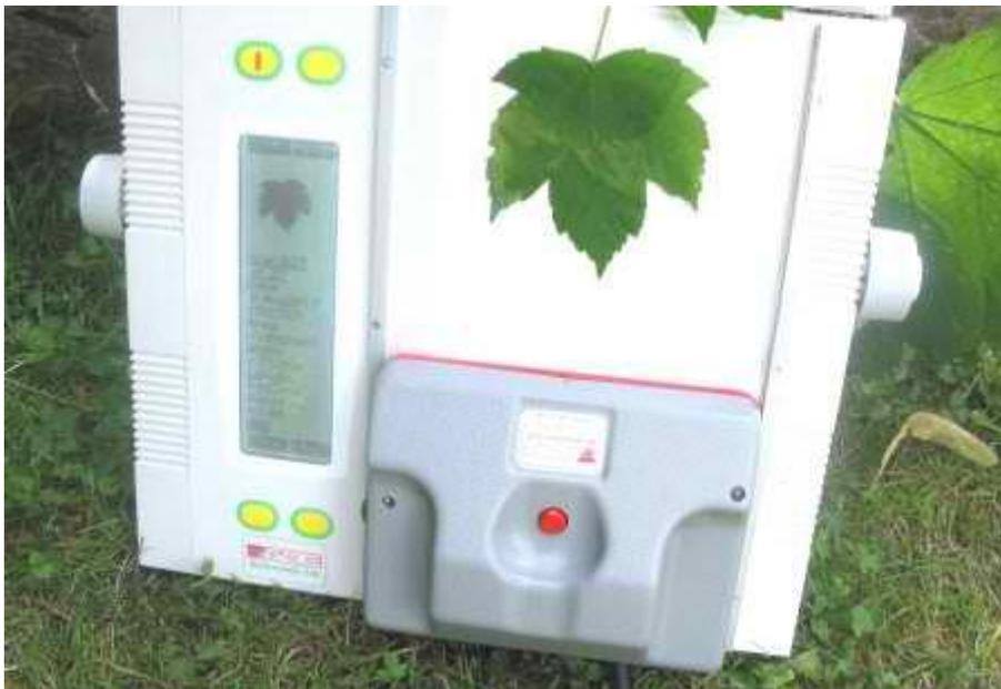
*Image 2 : Type de planimètre utilisé pour la mesure de la surface foliaire*
