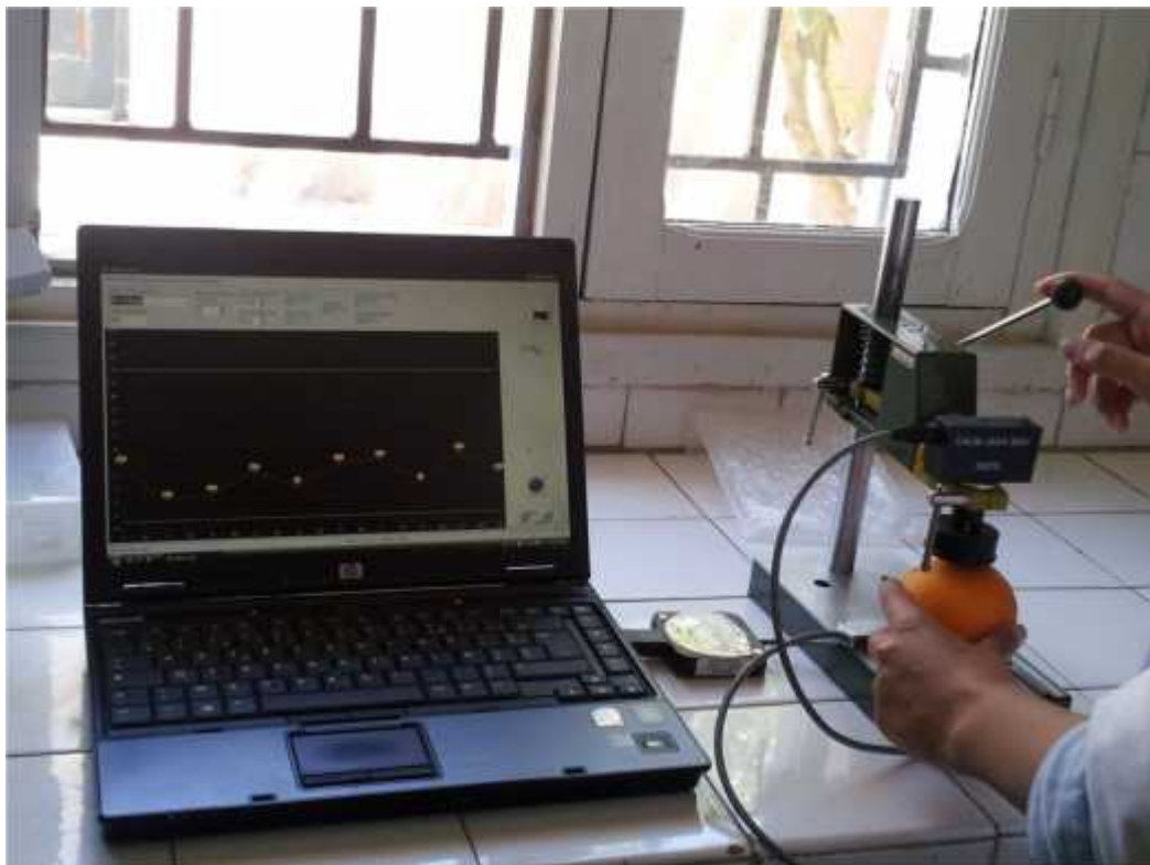
Figure13; La mesure de fermeté d'une orange et enregistrement automatique des résultats
