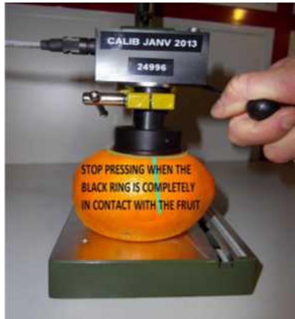
Figure9 : La détermination de la fermeté d'une orange par un pénétromètre
