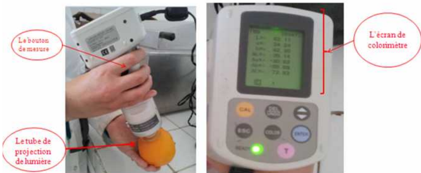
Figure12 : la mesure de la coloration d'une orange par le colorimètre (à gauche) et le résultat obtenu (à droite)
