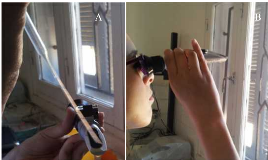
Figure 14 : le dépôt de gouttes de jus sur le plateau de prisme (A), et la lecture de résultat en orientant le réfractomètre vers la lumière (B)
