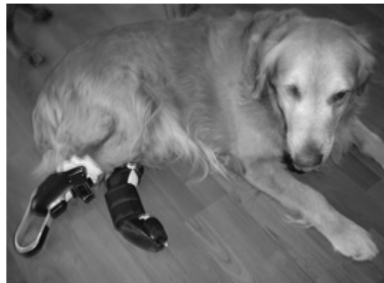
Photographie n°2 : Appareillage mixte orthèse (postérieur gauche) / prothèse (postérieur droit)
