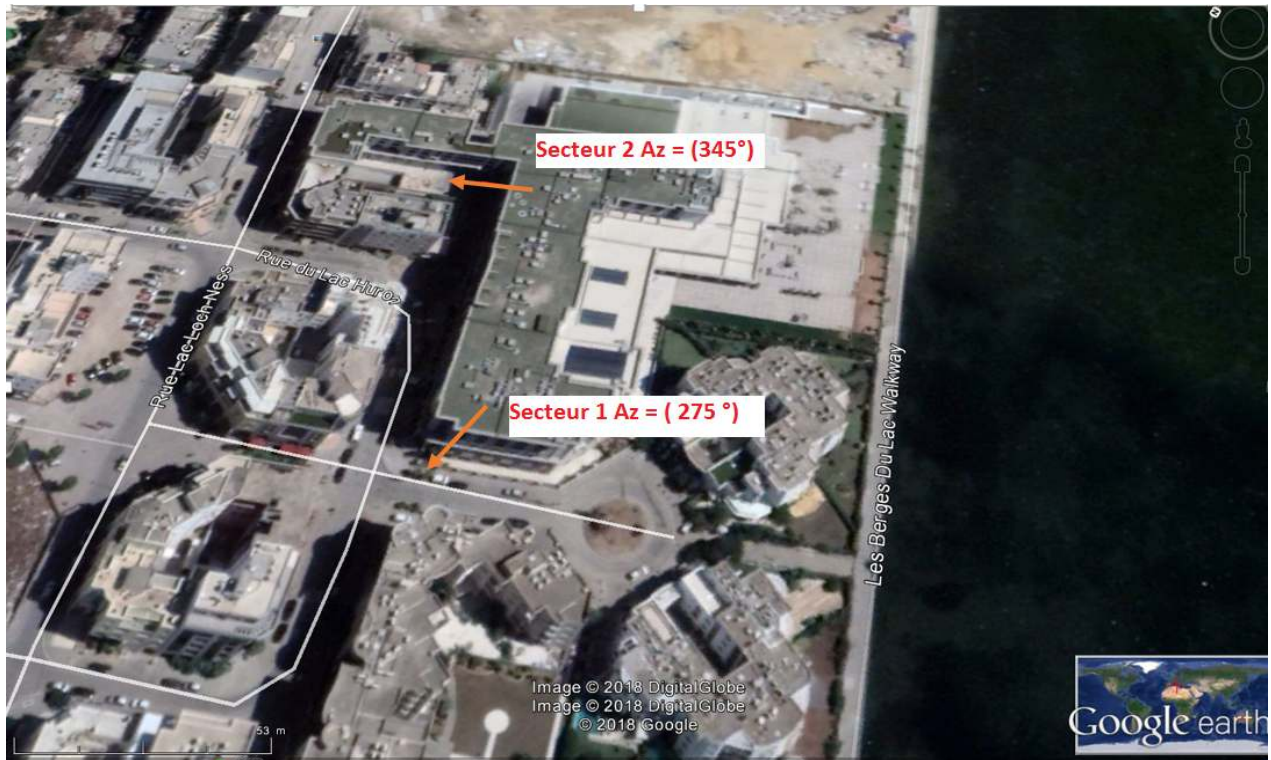
Figure 35 : Les deux azimuth de la solution Outdoor
