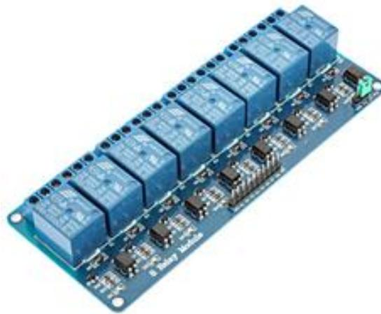
Figure 10- Module de relais à 8 canaux [N5]
