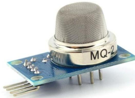
Figure 14- Capteur de gaz/fumée (MQ-2)
