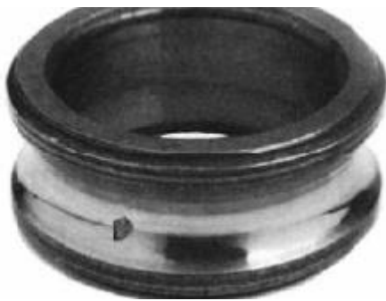
Ecaillage de la bague intérieure
