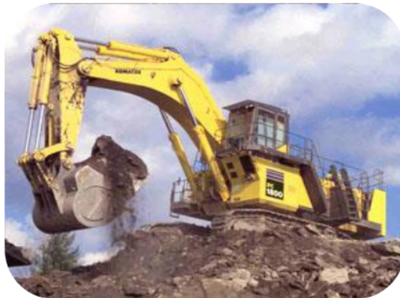
FIGURE 1.5 – Défruitage par les pelles hydrauliques
