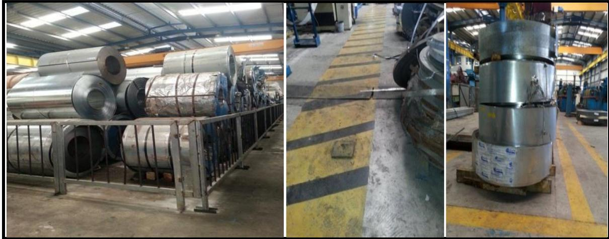
Figure IV.16: Délimitation des zones de stockage des bobines par des barrières.
