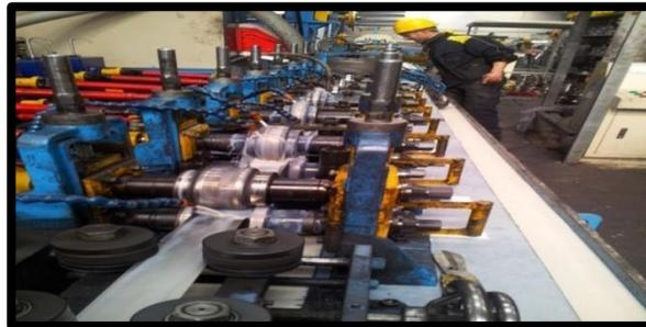
**Figure I.16:** Rôle du premier bloc de galets dans la machine tube (01)
