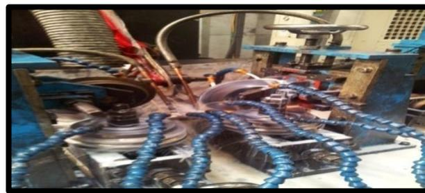
**Figure I.17:** Soudage du tube par induction haute fréquence
