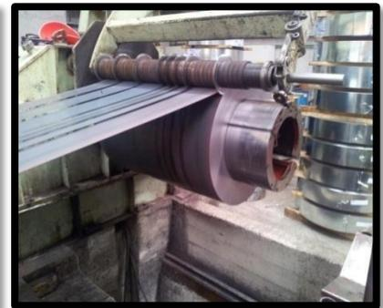
**Figure I.8** : Enroulement des feuillards produit
