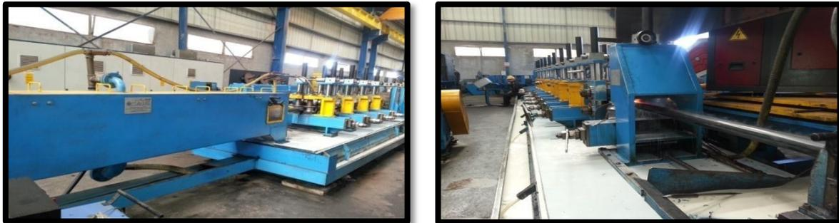
**Figure I. 19:** Refroidissement et calibrage du tube
