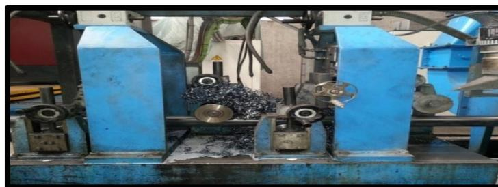
**Figure I.18:** Raclage cordant extérieur de soudure
