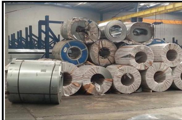
Figure IV.4: L'absence d'une zone propre pour le stockage des bobines.
