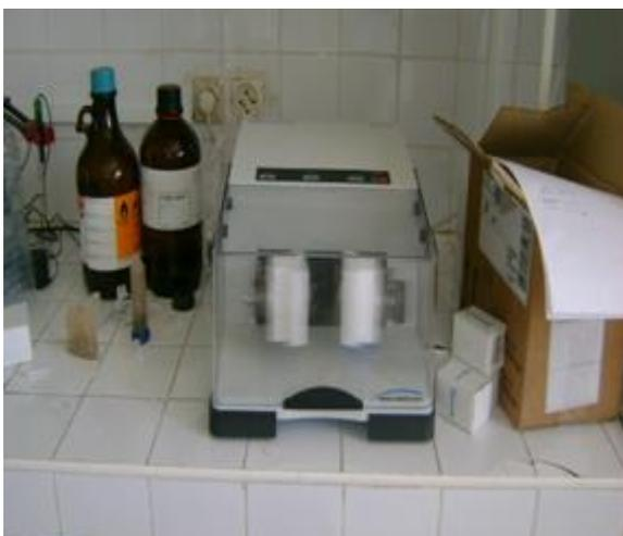
**Figure 11a: Broyeur à billes.**
