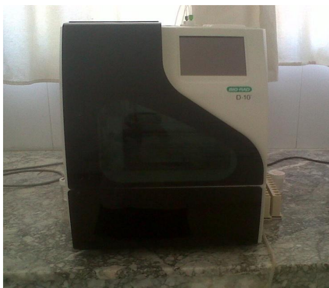
Figure1 : vue latérale de l'HPLC (Bio-Rad D-10)
