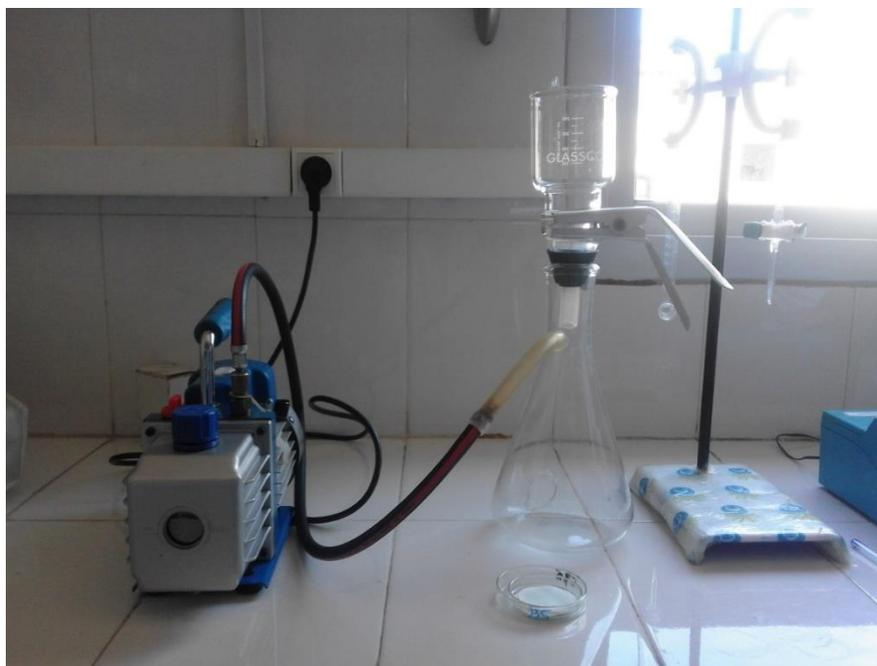
**Figure (6) : filtration sous vide des échantillons à l'aide d'une pompe.**
