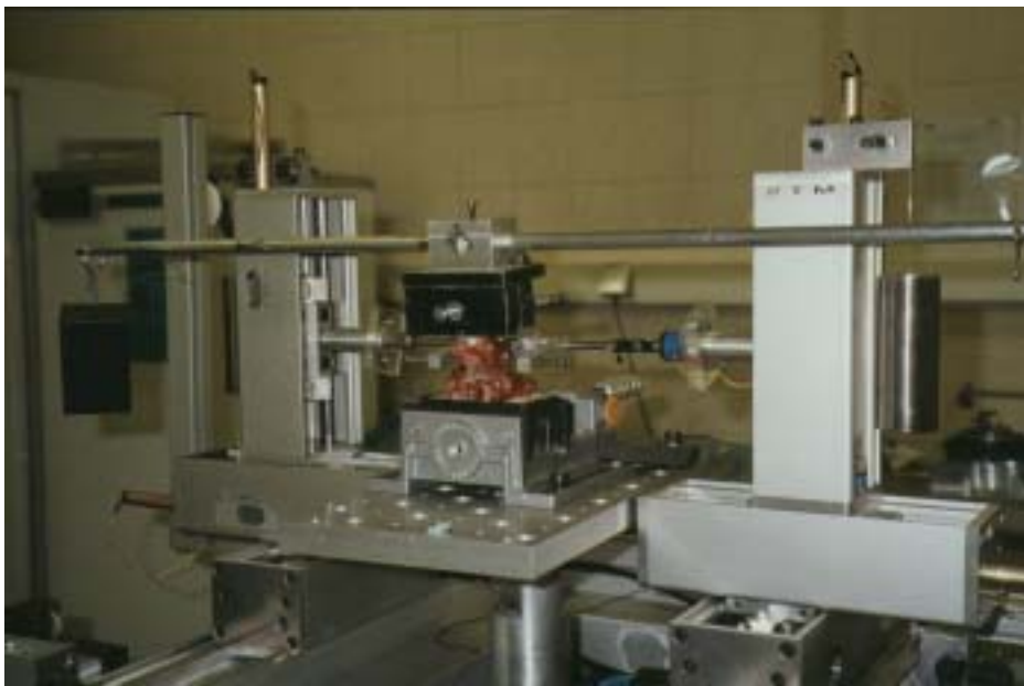
Figure 24 : colonne lombo-sacrée dans son socle de résine, fixée sur le dispositif 2TM
