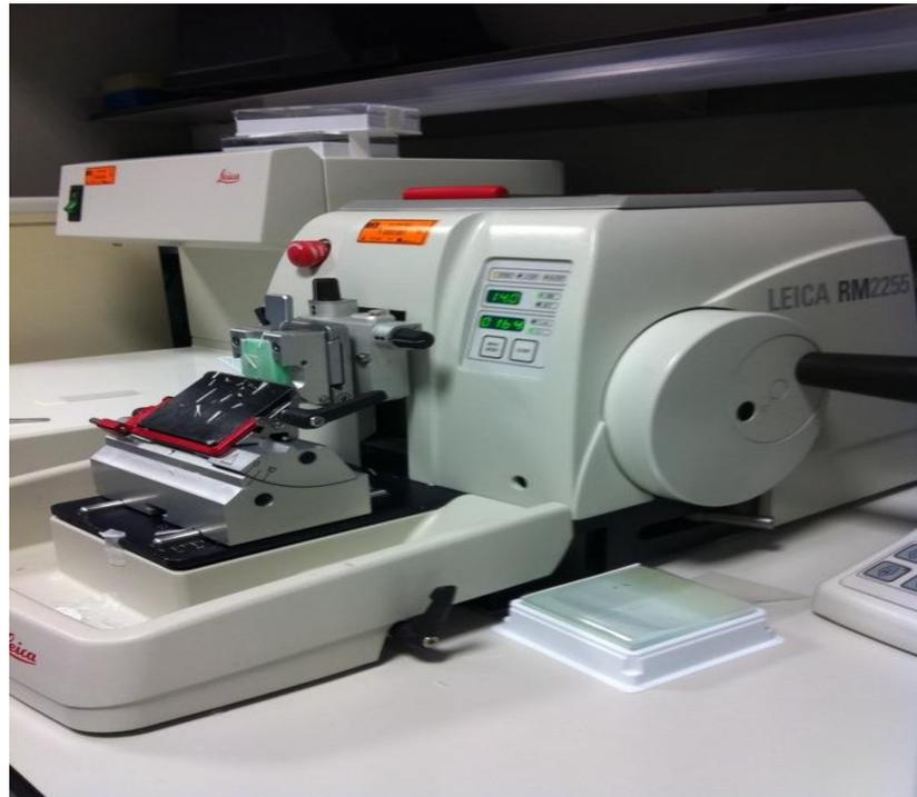
**Figure 7:**Photo d'un microtome Leica RM 2255.
