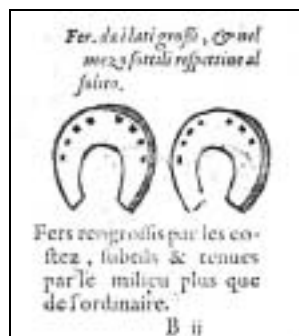
Figure 20: Fers à rive externe plus épaisse et rive interne plus fine pour les pieds combles (6).
