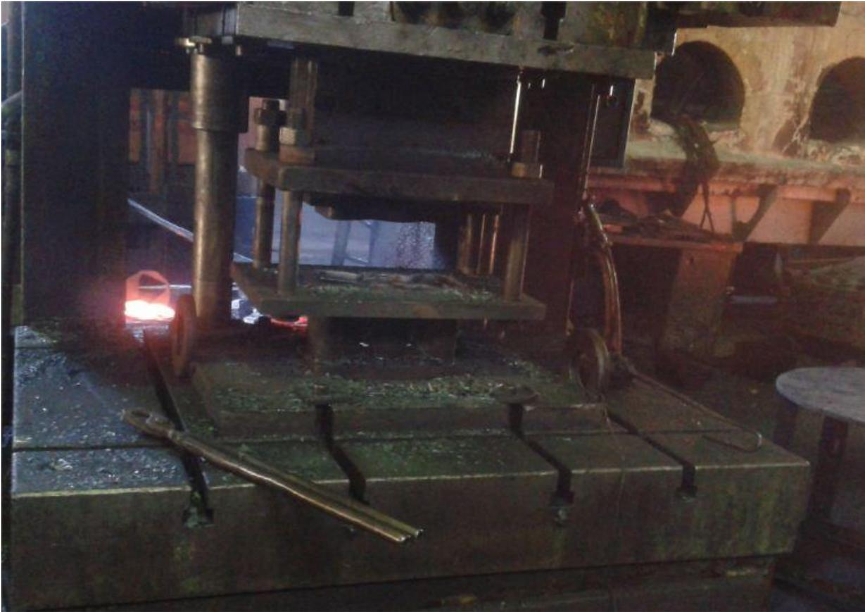
Figure 8 : l'opération d'ébavurage, débouchage et poinçonnage
