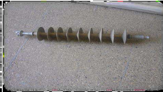
figure2 : Isolateur en composite
