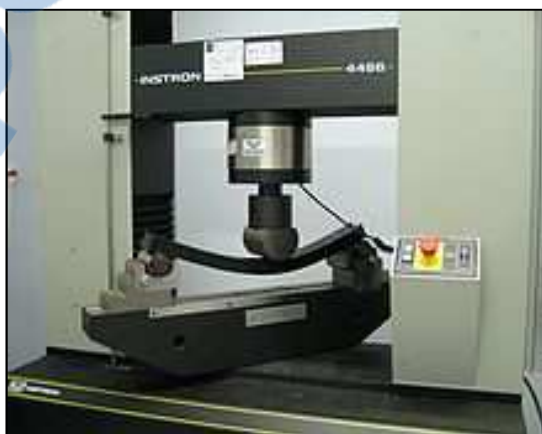
Figure 19 : Illustration d'un test de flexion 3 points
