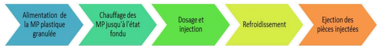
Figure 1.4 : Process d'injection plastique
