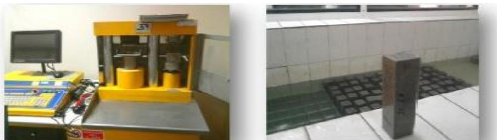
**Figure:17 Presse de flexion et compression et moule de béton**
