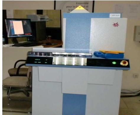
**Figure: 14 Spectroscopie à fluorescence X**
