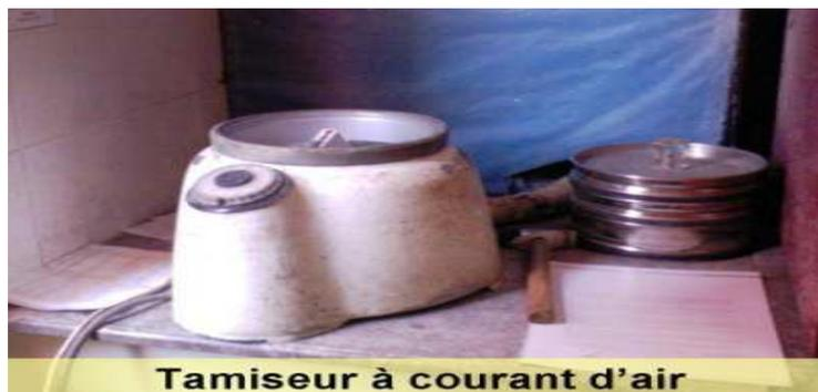
**Figure:18 Tamiseur à courant d'air**
