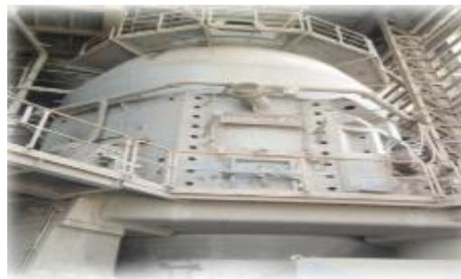
**Figure:12 broyeur à galets**
