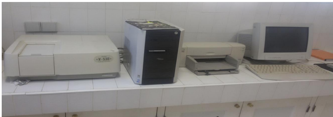
Figure 6 : Spectromètre JASCO V 530 double faisceau
