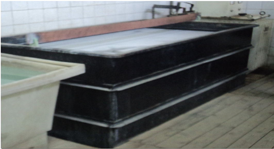
Figure5 : photographie d'un bain de dégraissage
