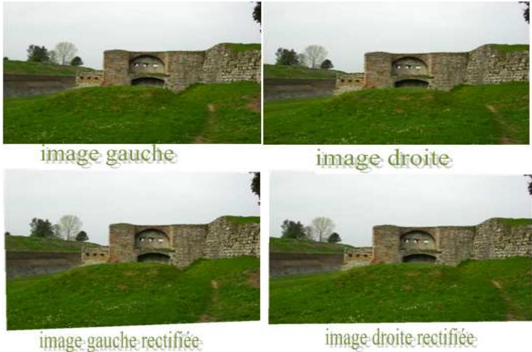
**Figure 2.5 : Images stéréoscopiques avant et après rectification épi-polaire**
