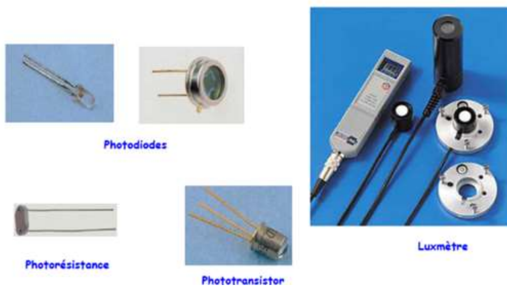
Figure 1.12 Type de mesurande : grandeur de Rayonnement (Radiatives, Capteurs de lumière).
