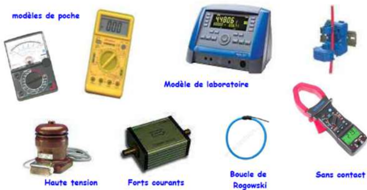
Figure 1.11 Type de mesurande : grandeur électrique (Mesure de tension/courant).
