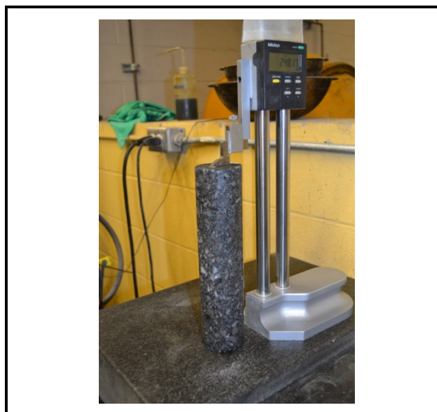
Figure 3.16 Photo du vernier sur pied utilisé pour la mesure de la largeur des éprouvettes
