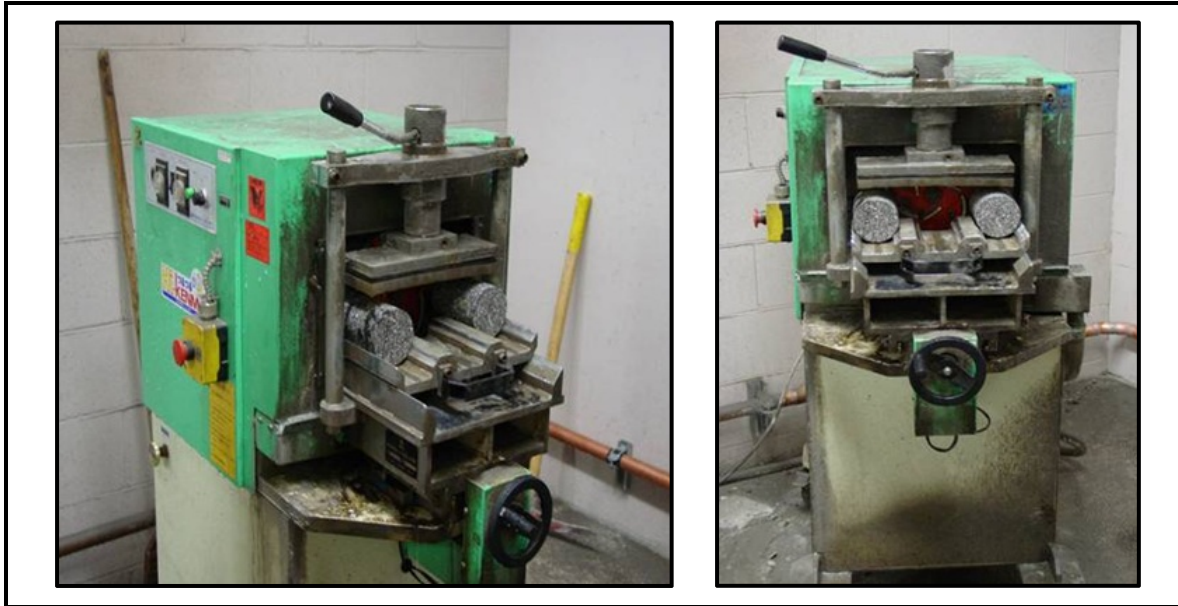
Figure 3.15 Photos de la rectifieuse utilisée pour procéder au resurfage des éprouvettes
