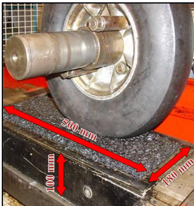
Figure 3.12 Photo illustrant le positionnement et les dimensions des plaques dans le compacteur pour une plaque d'enrobé de surface (GB-20)
