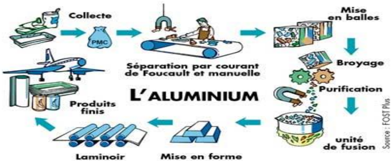
Figure III.16 : processus de recyclage d'aluminium
