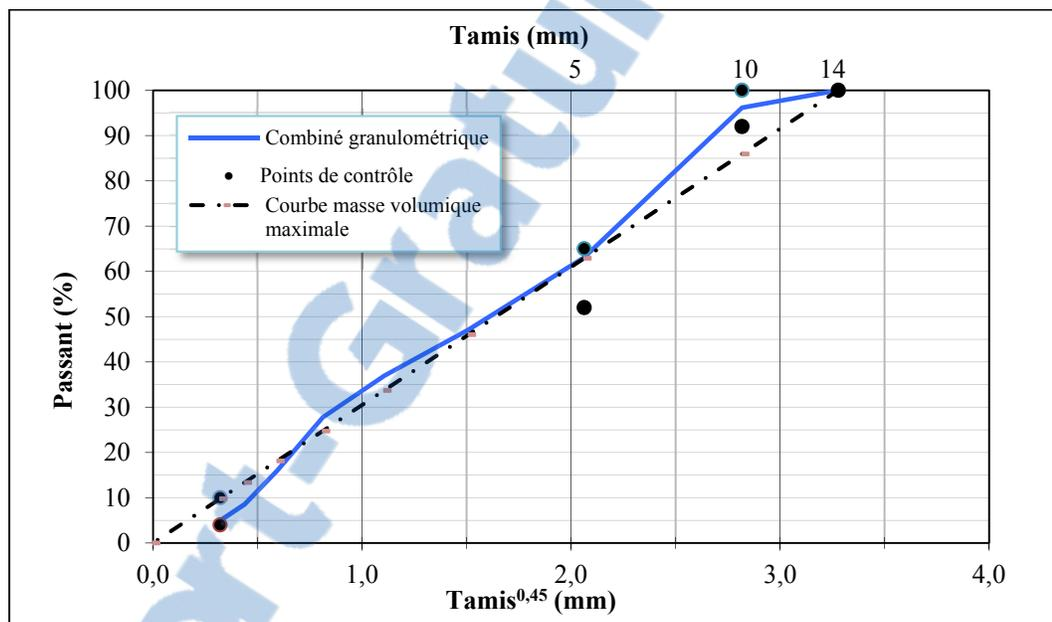
Figure 5.1 Granulométrie des enrobés par rapport aux points de contrôle du fuseau granulométrique et à la CMVM
