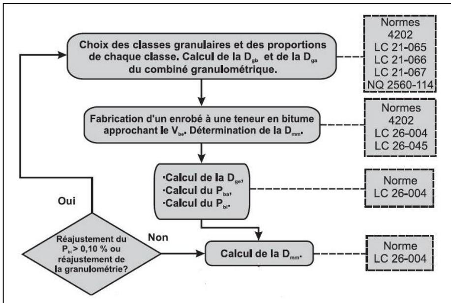
Figure 3.4 Étape de calcul pour la formulation d'un enrobé
