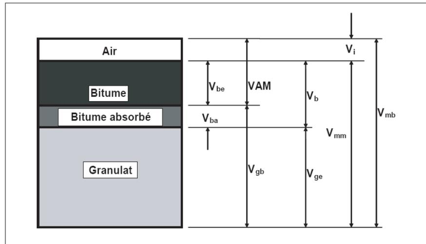
Figure 1.1 Représentation en volume absolu d'un enrobé compacté
