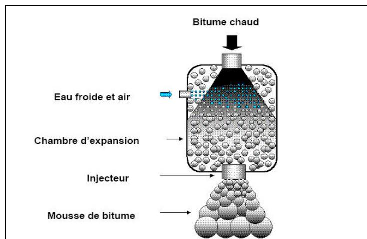
Figure 1.6 Procédé de moussage de bitume
