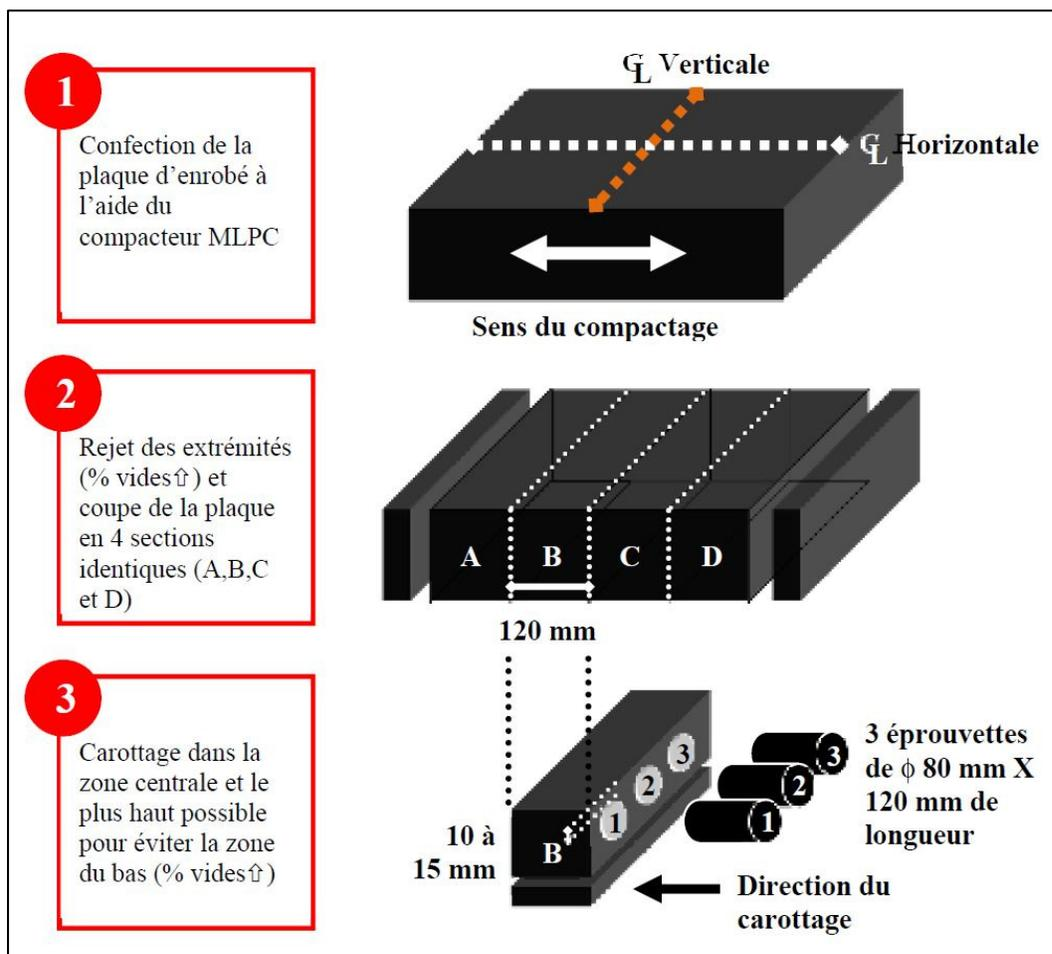
Figure 3.10 Plan de carottage pour les éprouvettes du module complexe
