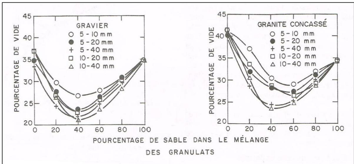
Figure-A II-2 Effet d'une combinaison granulaire sur la porosité
