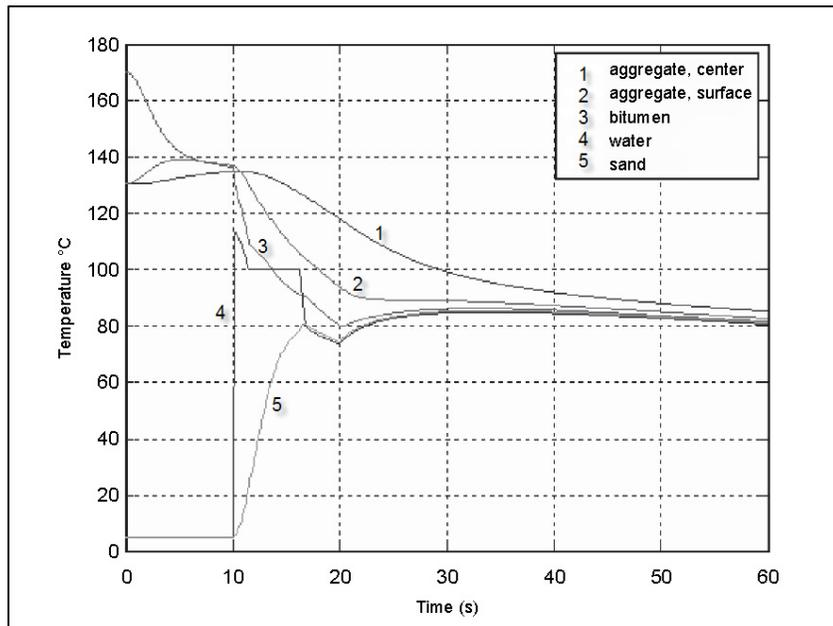
Figure 2.2 Évolution de la température des matériaux durant le malaxage d'un enrobé à basse énergie
