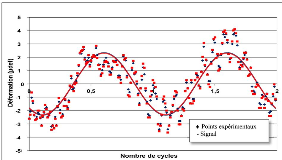
Figure 3.15 Représentation d'un mauvais indice de qualité du signal
