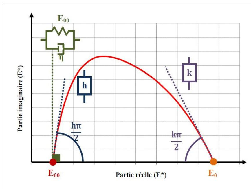
Figure-A V-1 Influence des paramètres du modèle 2S2P1D sur le module complexe représenté dans le plan Cole-Cole
