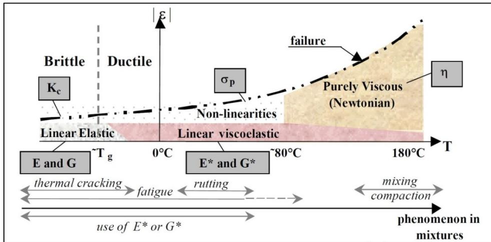
Figure 1.4 Classe de comportement du bitume selon la température (T) et l'amplitude de la déformation ( $|\epsilon|$ )
