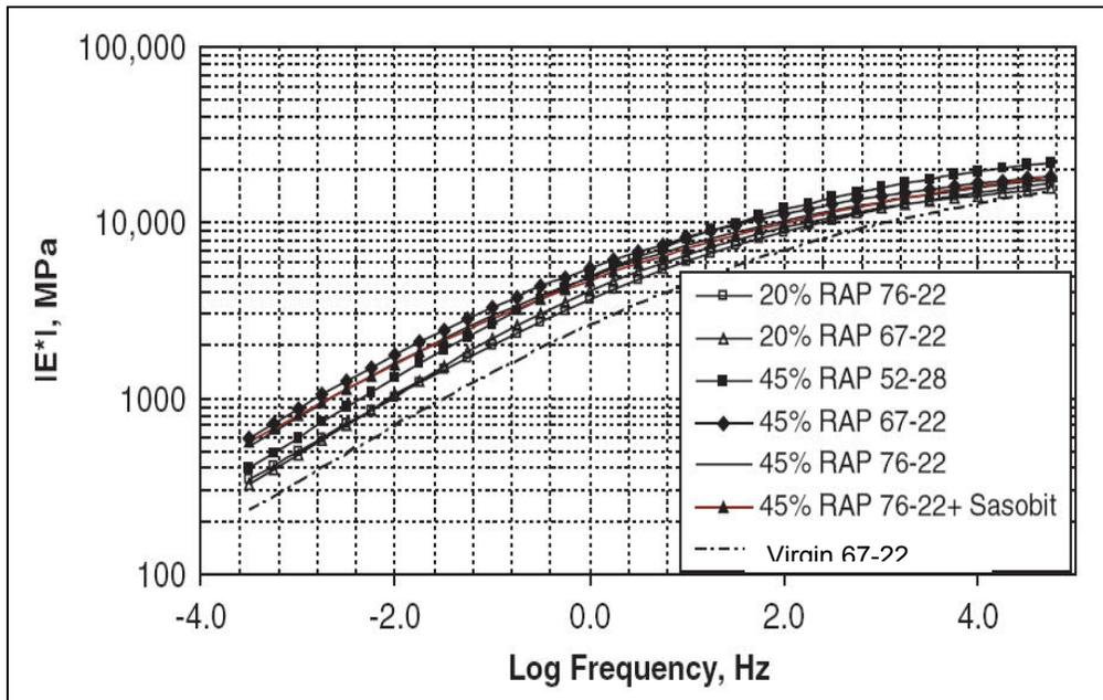
Figure 1.14 Courbes maîtresses du module complexe pour différents enrobés
