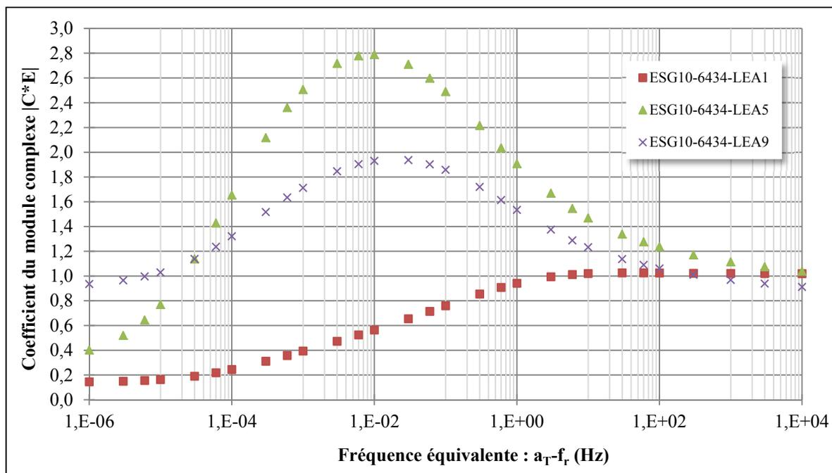
Figure 6.17 Évolution des écarts des coefficients de la norme du module complexe pour les enrobés EBE confectionnés avec un bitume PG 64-34 ( $T_{\text{réf}} : 10 \text{ °C}$ )
