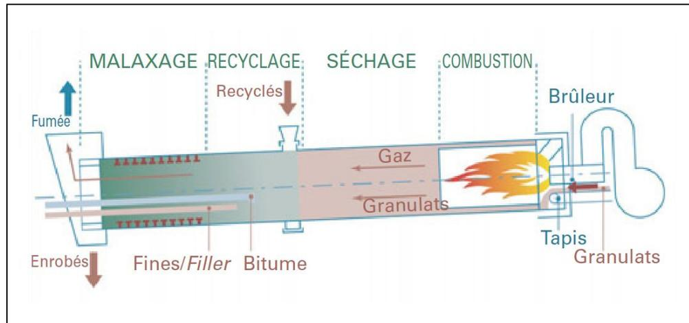
Figure-A III-1 Exemple d'une centrale d'enrobage continue avec recyclage à éqicourant
