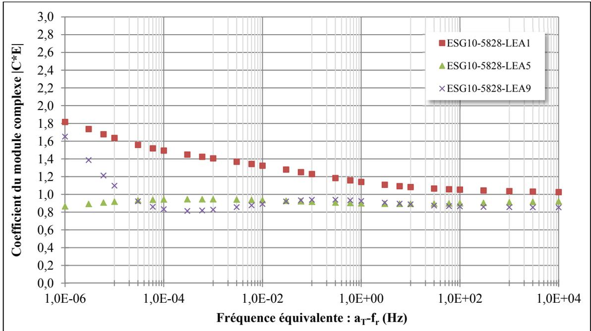
Figure 6.14 Évolution des écarts des coefficients de la norme du module complexe pour les enrobés EBE confectionnés avec le bitume PG 58-28 ( $T_{\text{réf}} : 10 \text{ }^{\circ}\text{C}$ )
