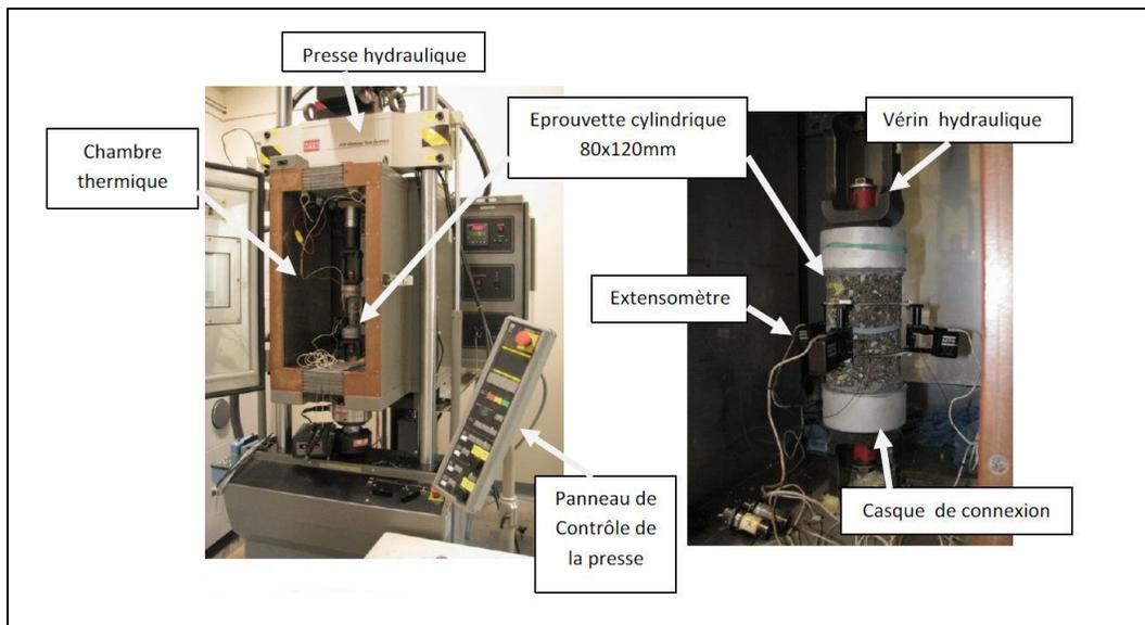
Figure 3.11 Montage de l'éprouvette pour l'essai du module complexe
