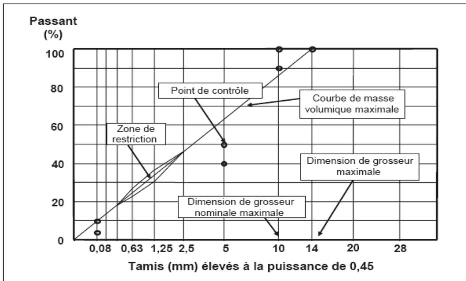
Figure-A II-3 Courbe de masse volumique maximale d'un granulat de dimension de grosseur maximale de 14 mm
