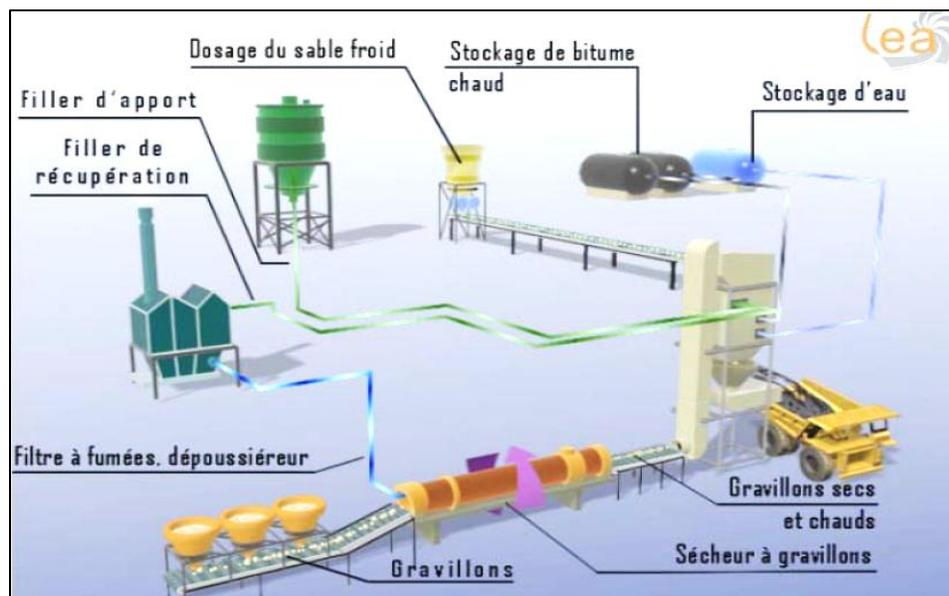
Figure 2.4 Installation d'une usine pour la fabrication d'un enrobé EBE
