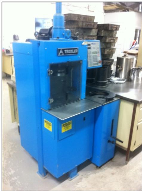
Figure 3.6 Presse à cisaillement giratoire utilisée de marque Troxler
