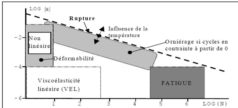
Figure 1.15 Classes de comportement type des enrobés
