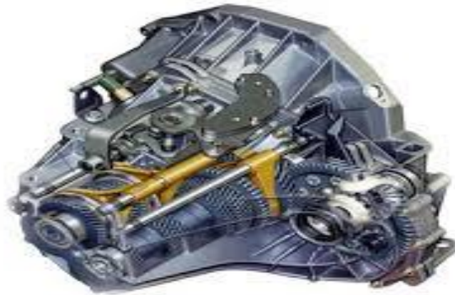
Figure I.1 Représentation d'une boîte à vitesse [3].
