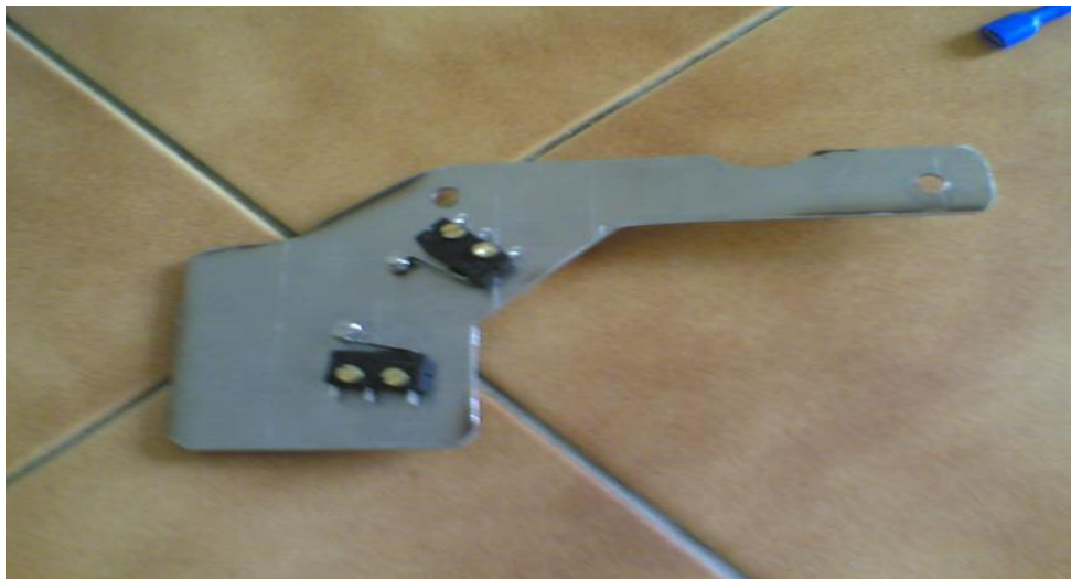
Figure III.13 L'emplacement de micro-inverseur à retour automatique dans une lamelle de zinc de motocyclette [5].
