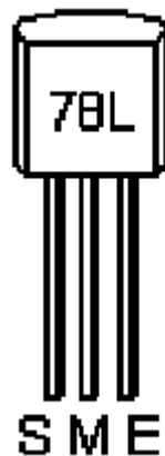
Figure 17 : Brochage de régulateur 78L08.
