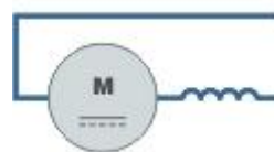
Figure .II.5 : Modélisation électrique d'un moteur à excitation série.
