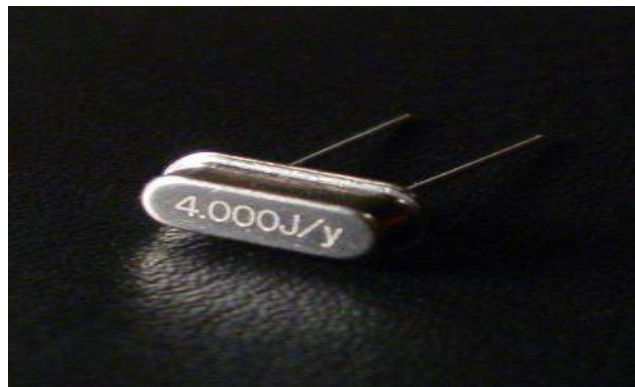
Figure : 06) Un quartz de 4 MHz dans un boîtier hermétique HC-49/US
