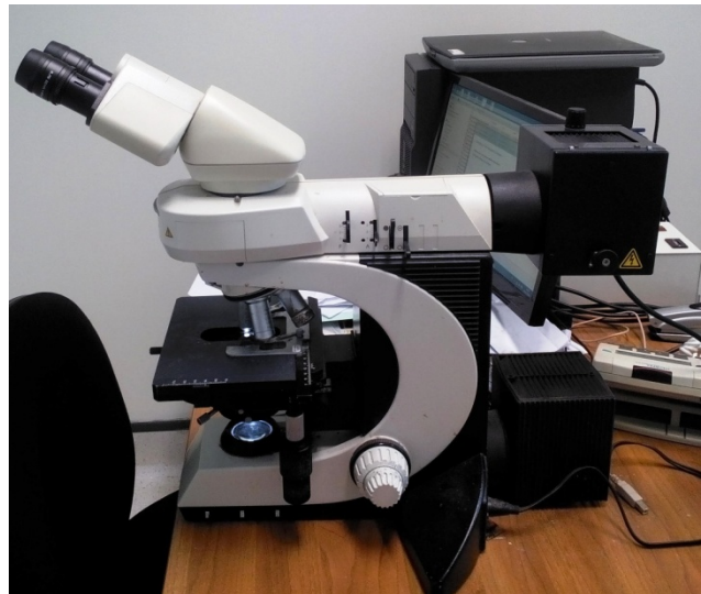
Figure 29: Microscope Leica® utilisé dans la lecture de l'immunofluorescence directe et indirecte. Collection Dr MO. Ait Si Ali, Dr M. Medjamia
