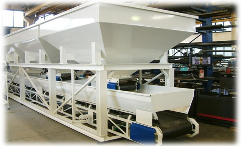
Figure III.2 : cuve avec leur support
