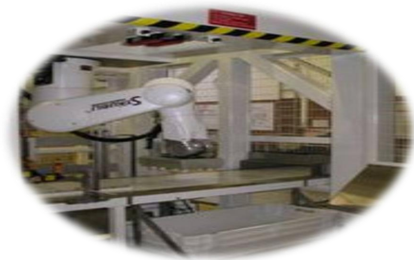
Figure 1.9 : Robot pour conditionnement du fromage râpé
