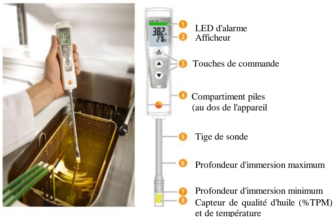
Figure II'.4 : Photo et représentation schématique du testeur d'huile de friture « testo 270 ».
