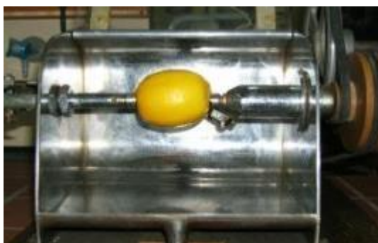
Figure I.12 : Photo du dispositif de l'expression à froid.
