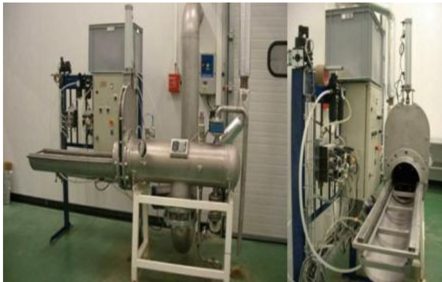
Figure I.17 : Appareillage du procédé de l'extraction par DIC 31 .
