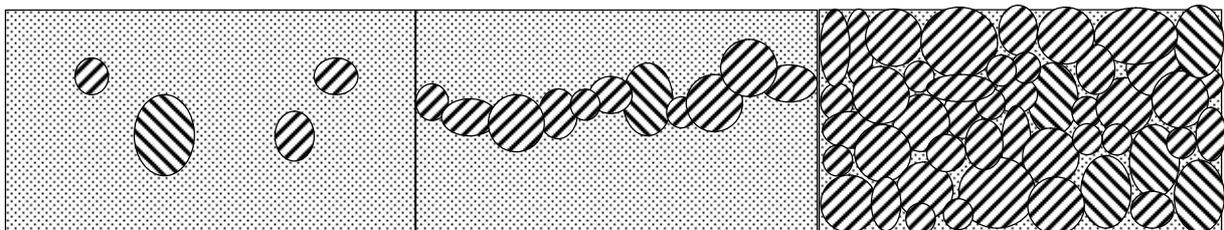
*Figure 1.8. Configurations de base du  $\mu\text{-Si:H}$ : grains nano(micro)cristallins isolés(a); zones cristallines formant des chemins de percolation (b); couche complètement cristalline avec un désordre aux joints de grains (c).*
