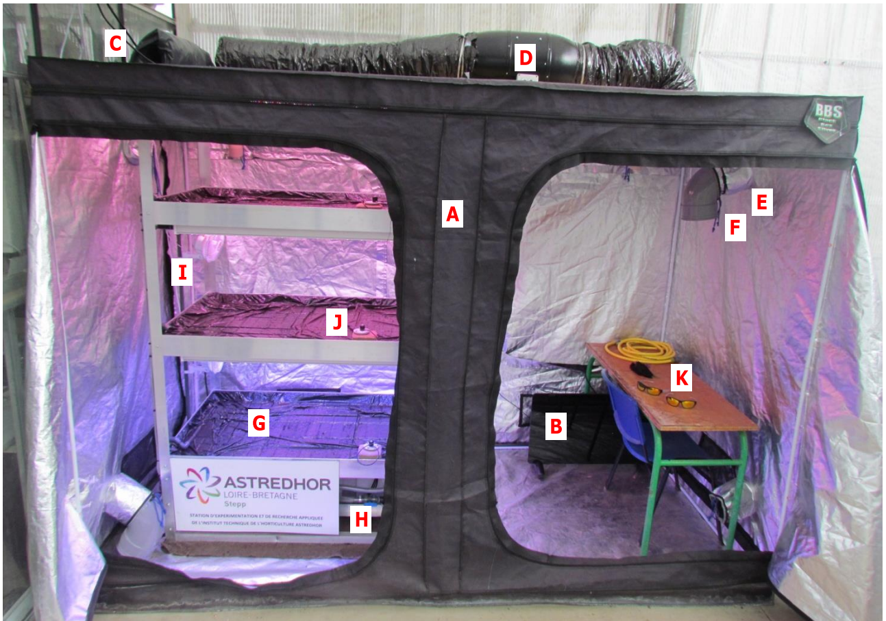
▲ Figure 10. Dispositif en chambre de culture type « blackbox » (A) avec un environnement contrôlé et sous LEDs en SSL pour M2, M3 et M4 de l'essai préliminaire au projet IRRADIANCE de la STEPP. Chambre équipée d'un chauffage (B), d'un inducteur et un extracteur d'air (C et D), d'aérations scellées avec des filets « insect-proof » (E) et dont la lumière qui perce à travers est réorientée avec des coudes PVC (Polychlorure de vinyle) (F). Etagère à LEDs en 3 étages avec tablettes de subirrigation (G), réservoir d'eau contenant une pompe immergée (H) et ventilateurs à chaque étage (I). Mesure du rayonnement émis avec des capteurs (J). Observation du dispositif en SSL sous LEDs avec des lunettes protectrices adaptées (K) (VL, 2017).
