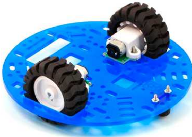
Fig.2.4 Exemple d'un châssis d'une plateforme différentielle [8]
