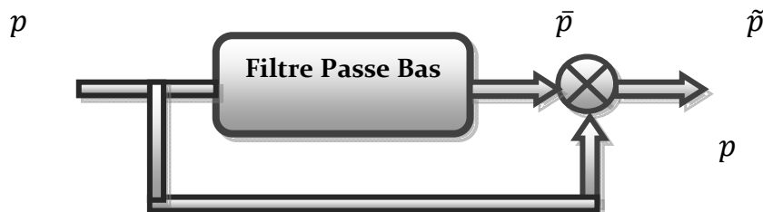
Figure II.6 structure d'un filtre passe bas
