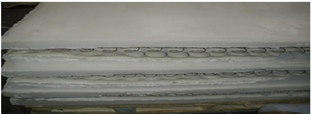
Figure 2.9: Schéma d'un matelas à sa sortie du four
