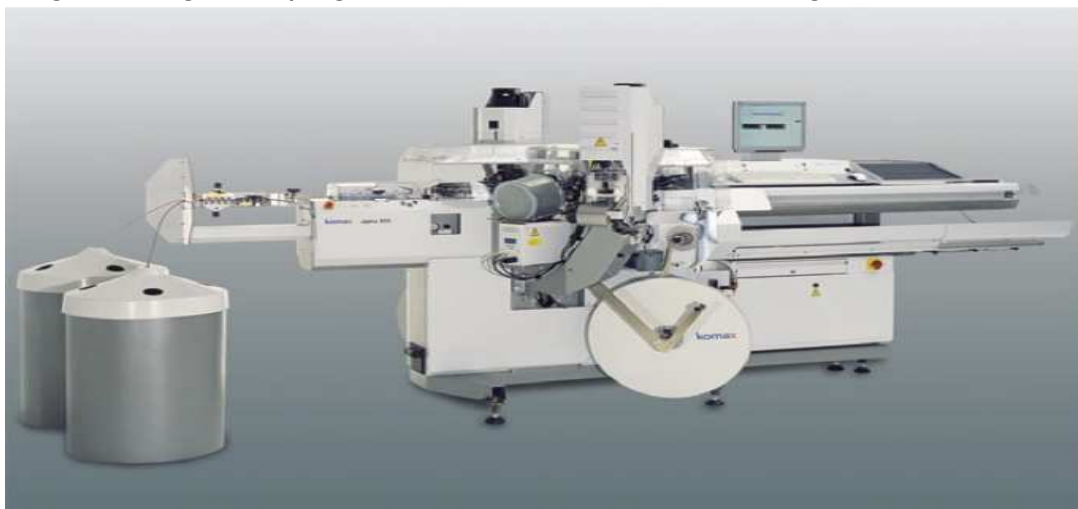
Figure 28: Machine pour sertissage automatique KOMAX ALPHA 355
