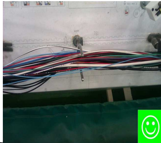
Figure 25 : non respect du trajet des fils
