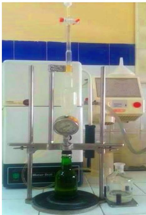
**Figure 16 :** Appareil de mesure des gaz étrangers (headspace)
