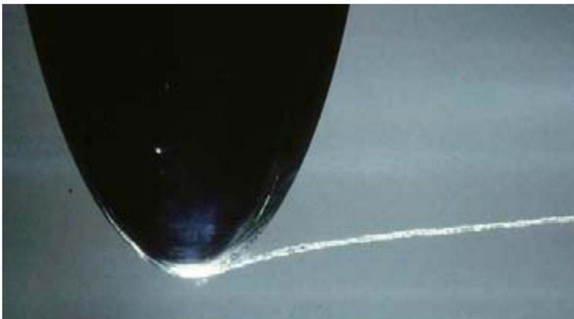
Figure I.8 : Cavitation par filaments tourbillonnaires [4]
