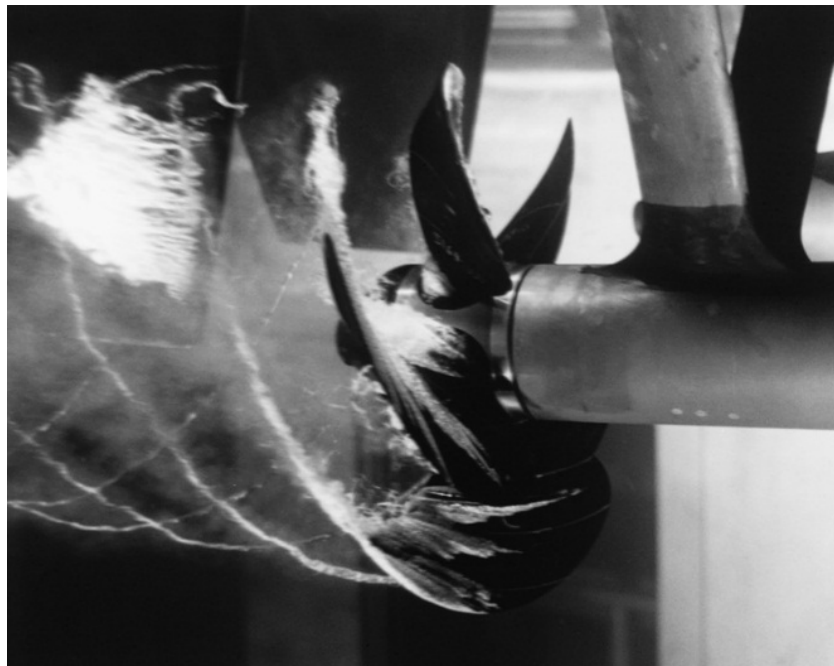
Figure I.4 Cavitation créée expérimentalement par une hélice dans un tunnel d'eau [4]
