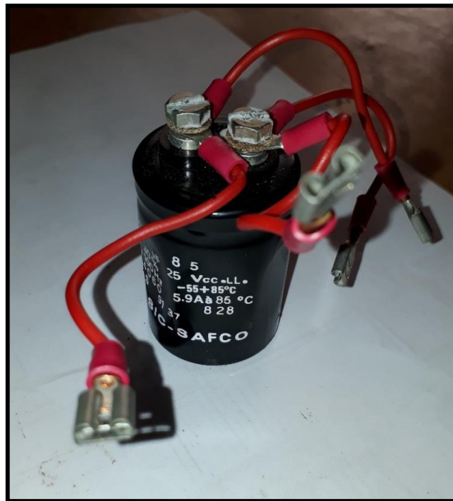
Figure4. 17 Condensateur après démontage
