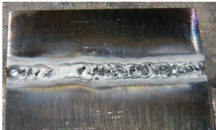
Figure 2.3. Porosités débouchantes en surface de cordon de soudure.
