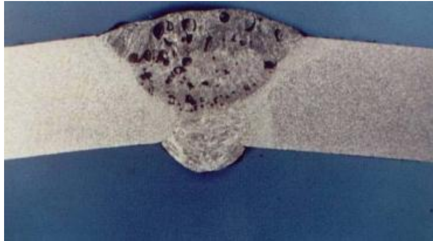
Figure 2.4. Macrographie d'une soudure avec soufflures.
