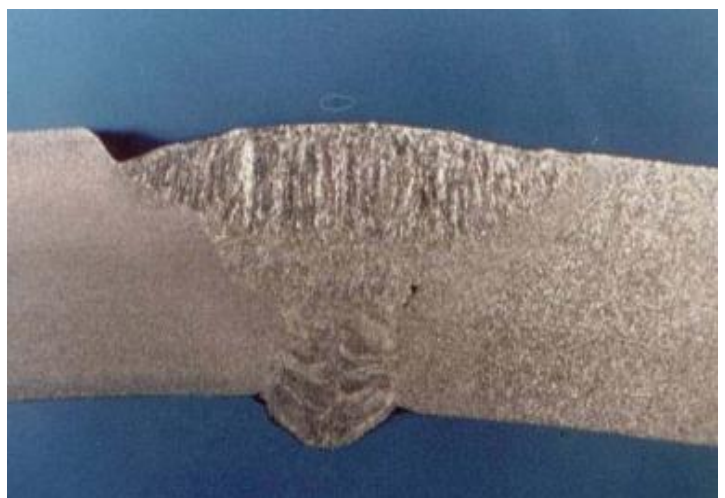
Figure 2.12. Caniveau en surface de joint soudé.
