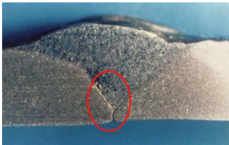
Figure 2.9. Manque de pénétration et collage en bord de chanfrein.
