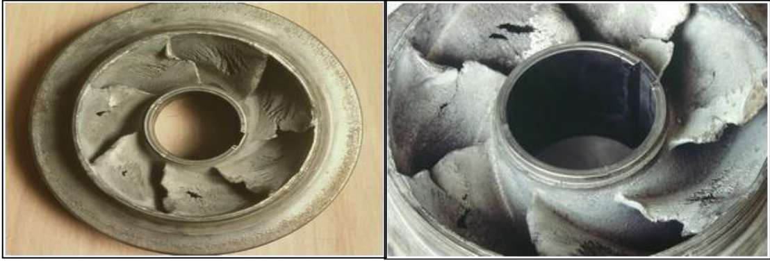
Figure 3-23 : Problème de cavitation
