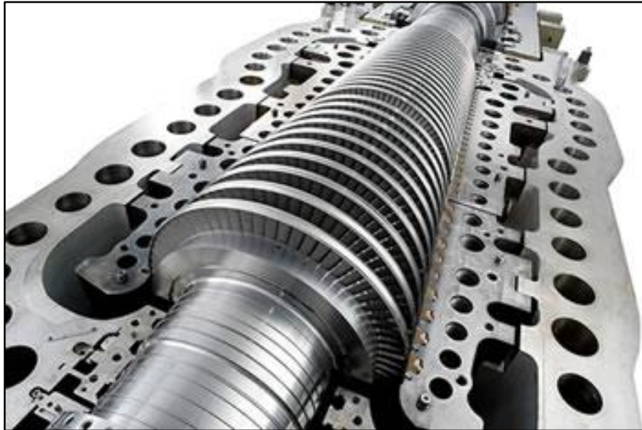
Figure(II.6) : Turbine à vapeur
