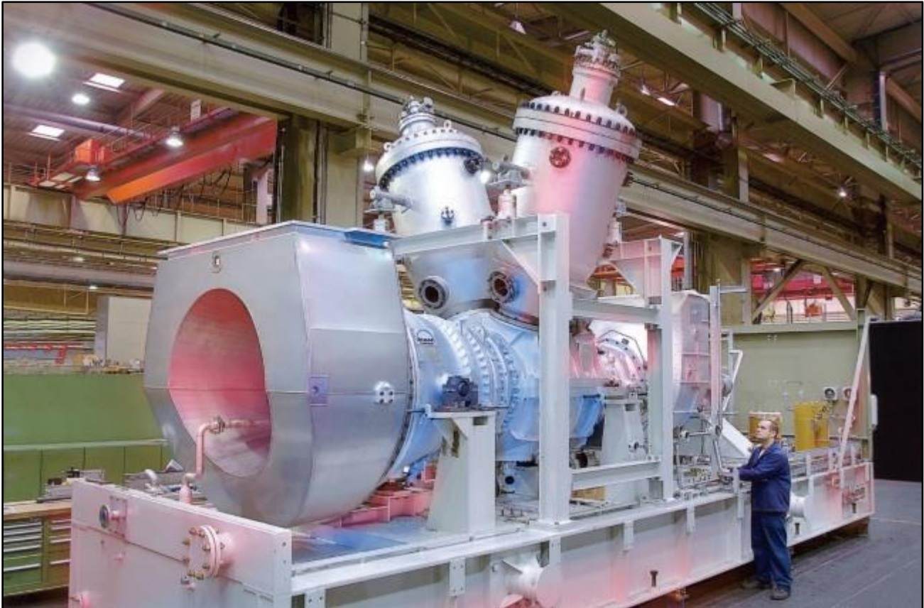
Figure(II.13) : Turbine à gaz MAN THM 1304
