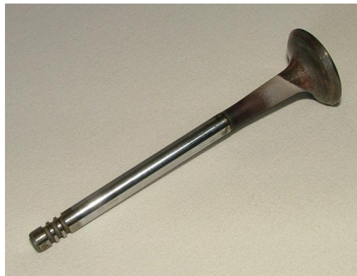
Fig.1.11 Une soupape à tige démontée d'un moteur thermique.
